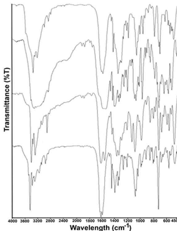
**Figure 2.** FT-IR spectra of the metal(II)- tryptophan complexes. (a) Co<sup>II</sup>, (b) Ni<sup>II</sup>, (c) Cu<sup>II</sup>, (d) Zn<sup>II</sup>.
