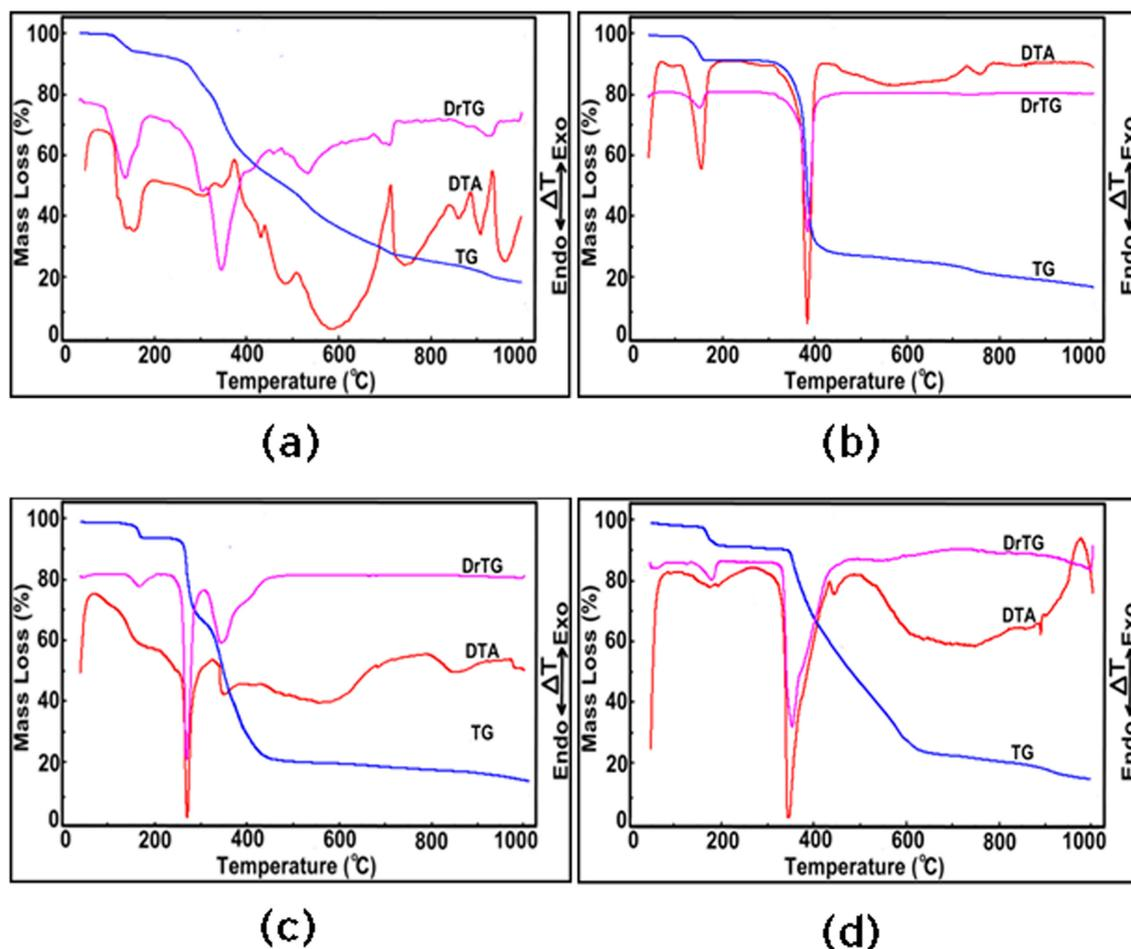
**Figure 3.** Thermal analysis curves of complexes. (a) Co<sup>II</sup>, (b) Ni<sup>II</sup>, (c) Cu<sup>II</sup> and (d) Zn<sup>II</sup>.
